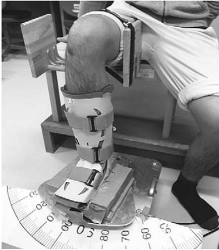
図1 簡易の下腿回旋可動域測定装置
